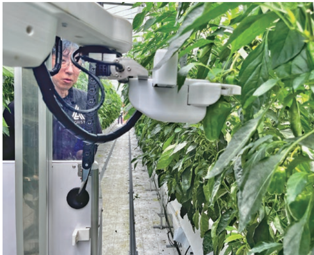
農作業用レールの上を自走しながらピーマンを収穫するロボット
